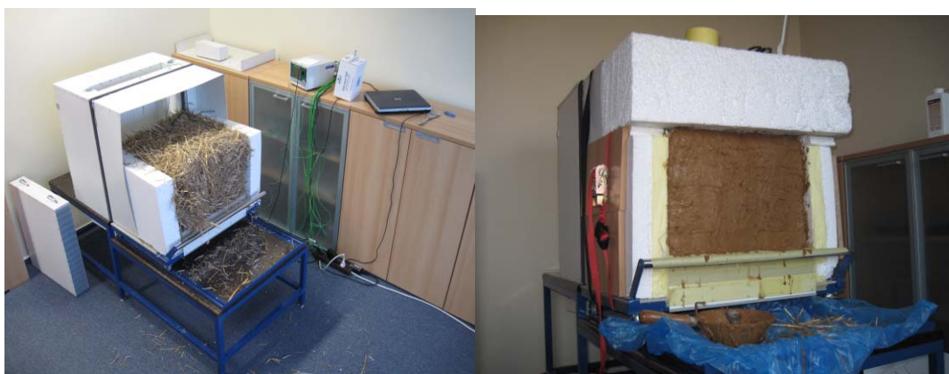
Obrázek 1 - slaměný balík v termokomore před měřením (vlevo), balík opatřený hliněnou omítkou (vpravo)
